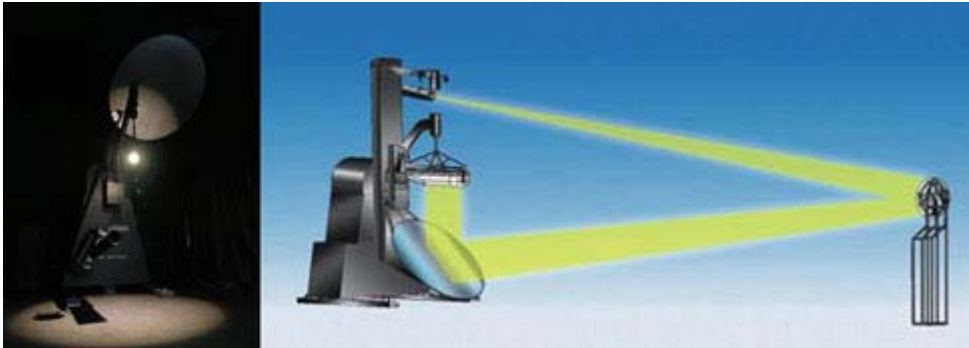
图 12 工研院量测中心之配光曲线仪及其量测光源路径示意
