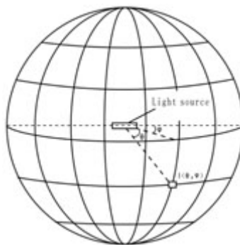
图 9 配光曲线仪测试光通量示意图
